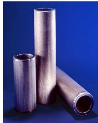
Фильтрующие элементы DUALSEP изготовлены с использованием плиссированной структуры, с двумя различными слоями: внешний слой обеспечивает высокую способность удержания грязи, внутренний слой обеспечивает агломерацию тумана в большие капли.
